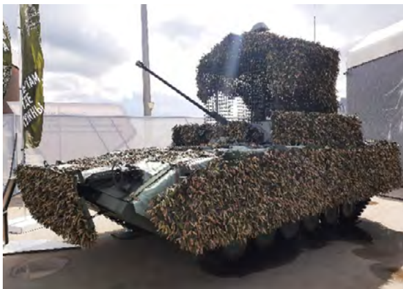
BMP-2 avec protection contre les drones d'attaque
